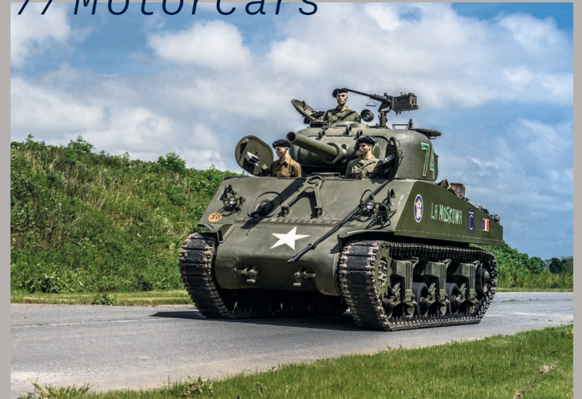
M4 Sherman "105mm Howitzer", produit par Chrysler au Detroit tank arsenal. "La Moskowa", char de la 2 ème DB du Maréchal Leclerc.
